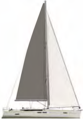
Battened mainsail / Grande voile lattée / Durchgelattetes Großsegel / Mayor con sables forzados / Randa steccata
