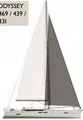
Short overlapping genoa / Génôis à faible recouvrement / Genua in geringer Überlappung / Génova con poco recubrimiento / Genoa a basso recupero
